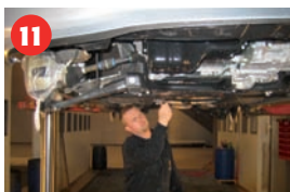
11 Undervognen undersøges for gennemtæringer og løs PVC.
