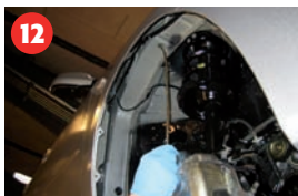
12 Alle bilens hulrum i vognbunden behandles med tyndt produkt
