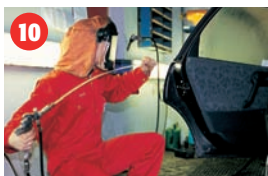
10 Bilens hulrum i overvognen, døre, klap o.lign. behandles med tyndt produkt.
