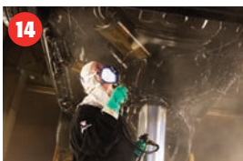
14 Påføring af slidlag på udvendig vognbund til beskyttelse af det tynde produkt
