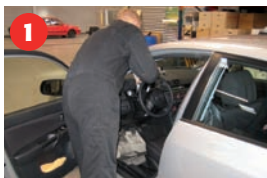
1 Afdækning af interiør, rat, måtter, gearstang, sæder og sikkerhedssele.
