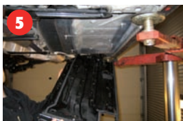
5 Store flader, kan ikke behandles hvis man ikke afmonterer alle bundskjold.
