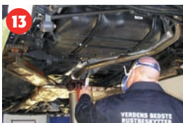
13 Den udvendige vognbund behandles med tyndt produkt
