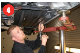
4 Alle skjold på undervognen afmonteres.
