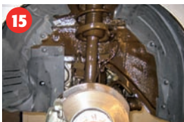
15 Færdigbehandlet hjulkasse efter montering af inderskærme.
