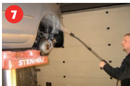
7 Højtryksrens af undervogn med varmt vand.
